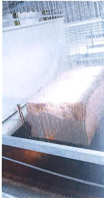
Le nouveau hall de sciage primaire, accueille deux nouveaux châssis Simec à 80 lames, et deux trilames PTM. Multilames, monolames et taille-blocs complètent l'équipement dans ce secteur.
