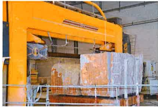
Le nouveau hall de sciage primaire, accueille deux nouveaux châssis Simec à 80 lames, et deux trilames PTM. Multilames, monolames et taille-blocs complètent l'équipement dans ce secteur.
